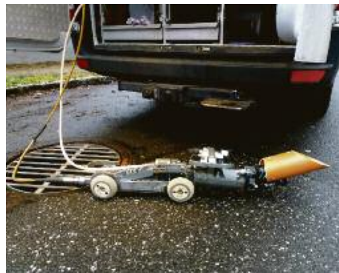
Von den Technikern liebevoll »Lisy« genannt: Die Kanalkamera zur optischen Inspektion der Leitungen. Foto: Tanzen
